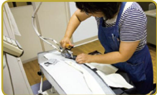
ウエスト部分の帯に切れ目を入れ、折り曲げてプレスすることで素材を自然体に維持させ、型くずれを防ぎ、美しい形を持続させるための中間プレス。見えないところにもこだわりが光る。
