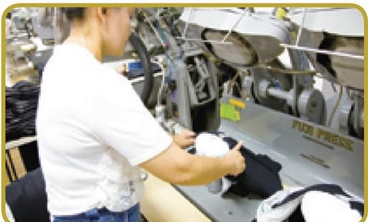
割縫いの小股部分は、スラックスの中でも唯一アイロンがかけにくい箇所。縫製後の縫い目を仕上げる小股専用のプレス機はエminentが独自開発したものだ。緩やかに丸みを持たせた形状で小股の微妙なフィット感も調整する。
