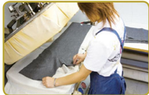
長年にわたり、日本人体型を細かくリサーチし作り上げたオリジナルの立体プレス機。尻の丸みに合わせて立体的にボリュームをつけることにより、一般的な日本人のヒップにシワなくきれいに沿うスラックスが仕立て上がる。この立体プレス機は蒸気・圧力をコンピュータ制御でき、生地に応じてプレス加減を調整可能。テラーなどではアイロンを使い手作業で仕上げるが、エminentスラックス松浦工場では、必要な箇所はあくまで均一で正確性を持つ機械を使った工程を取り入れている。
